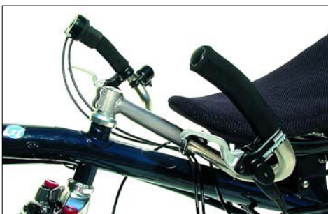
Der Lenker wird über den Vorbau mit der Gabel verbunden. Die Klemmverbindung zur Gabel erfolgt über die beiden seitlichen Schrauben.
