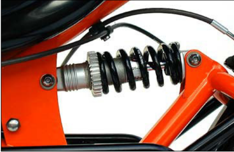
Federelement DNM DV-22 Durch das Drehen des Einstellringes am vorderen Ende der Feder stellen Sie die Federvorspannung ein.
