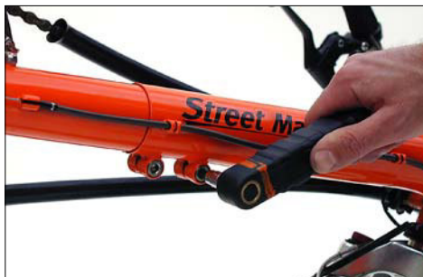
Lösen der Klemmschrauben zum Verstellen des Tretlagerauslegers.
