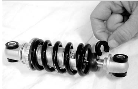
Durch das Aufstecken von Distanzclips auf die Kolbenstange des Federerelementes wird der Federweg eingestellt.
